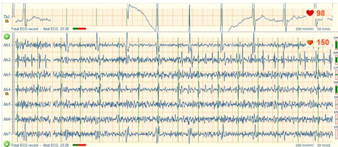
Figura 19. Interfaz del dispositivo Baby-Card, en la parte superior se puede observar el ECG materno, en la parte inferior se observan los 7 canales para observar el ECG fetal, la señal de estos varía por lo tanto su calidad también, es trabajo de los investigadores seleccionar el canal que presente la mejor señal [31].
